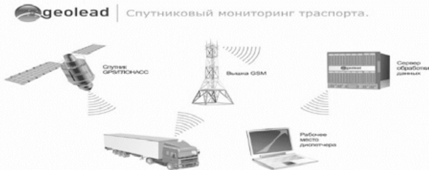
Рисунок 1. Схема взаимодействия систем спутникового мониторинга
